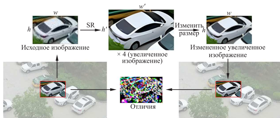
Рис. 3 Пример аугментации данных с помощью SR-сети
