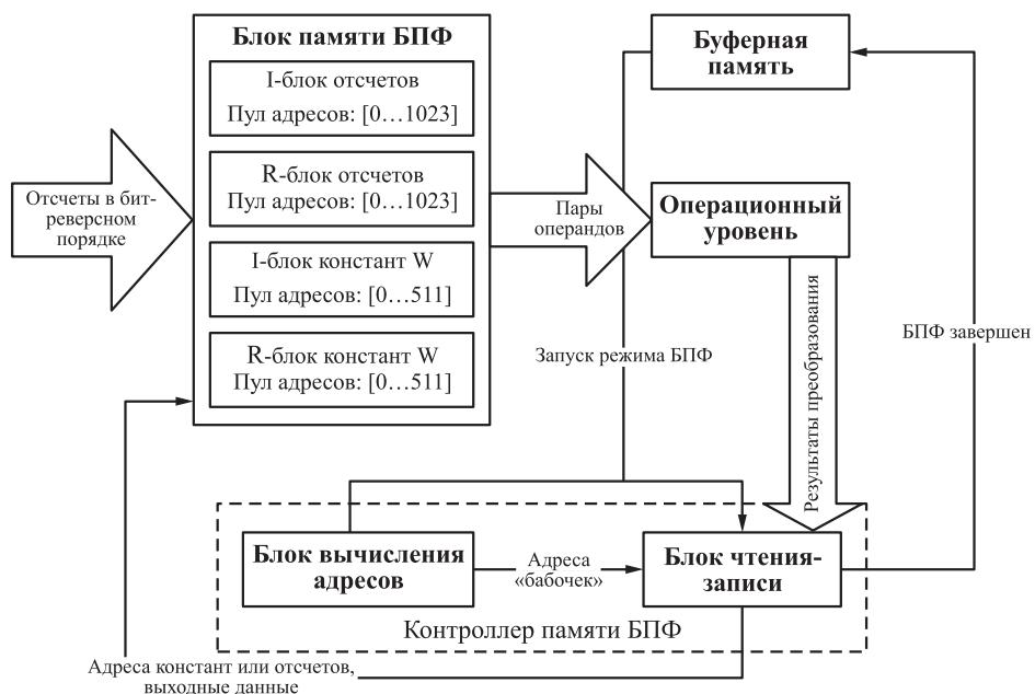
Рис. 4 Архитектура средств поддержки БПФ
