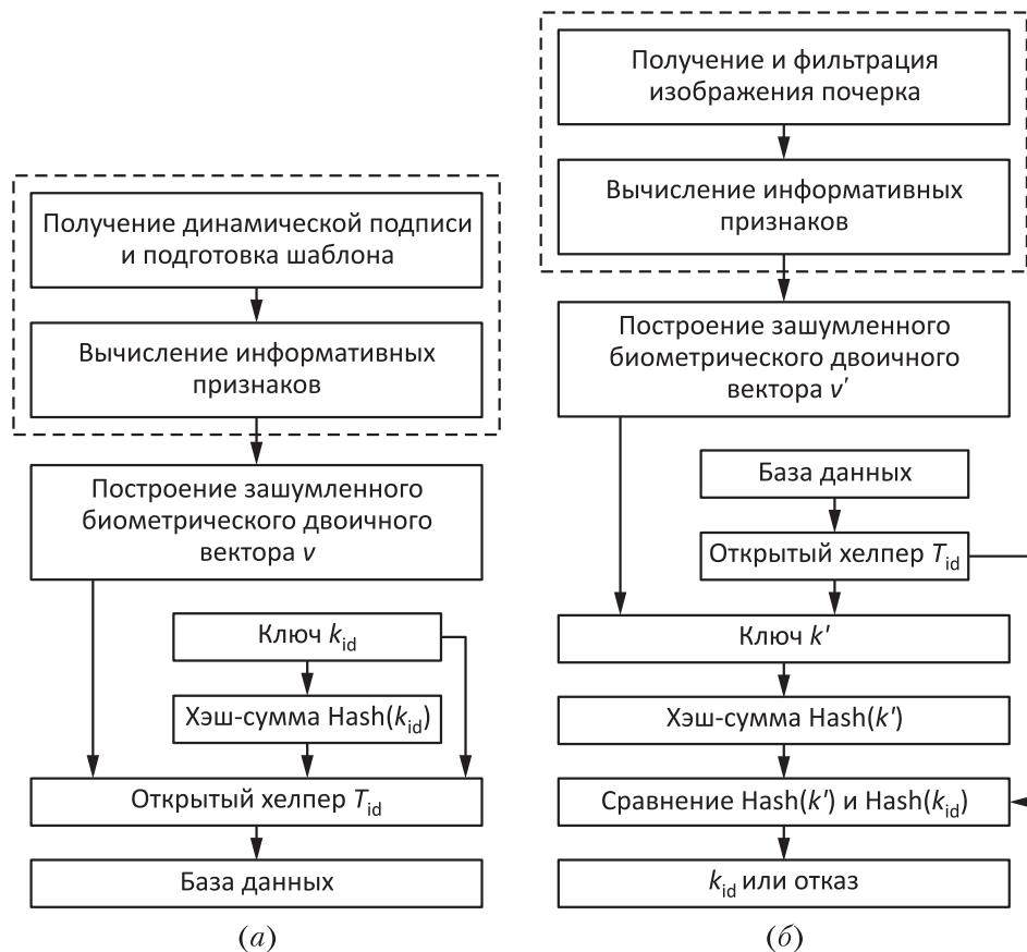
**Рис. 3** Блок-схема нечеткого экстрактора для биометрии подписи: (а) этап регистрации; (б) этап идентификации
