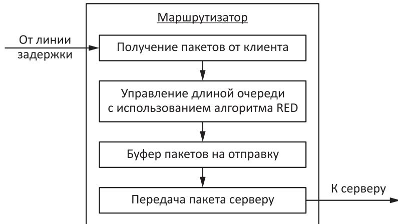
**Рис. 3** Структура модели маршрутизатора
