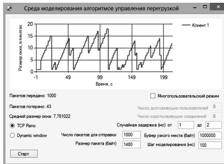
**Рис. 6** Пример моделирования процесса передачи данных (одна пара клиент–сервер)
