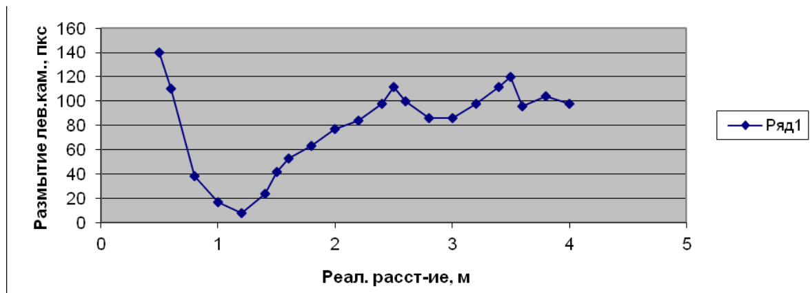
Рис. 2.4 Зависимость размытия от расстояния при измерении наблюдений с одной камеры
