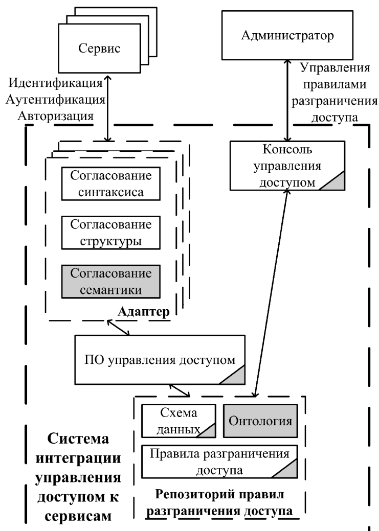
Рис. 2. Прототип и предлагаемое решение (новые блоки закрашены, развитые отмечены уголком)
