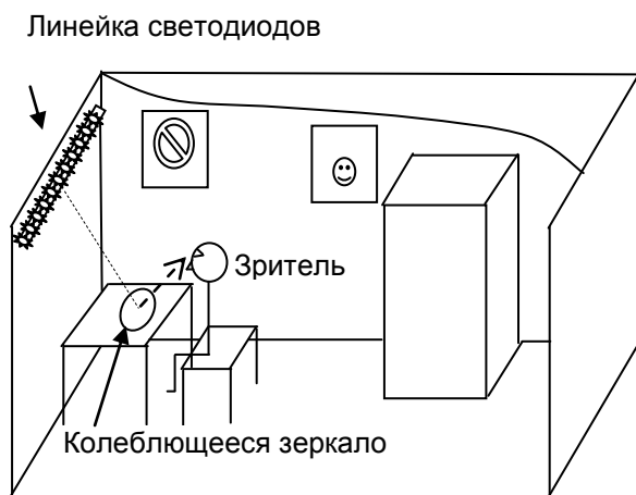
Рис. 4. Схема просмотра телевизионной передачи зрителем в колеблющемся зеркале, в котором отражается линейка светодиодов
