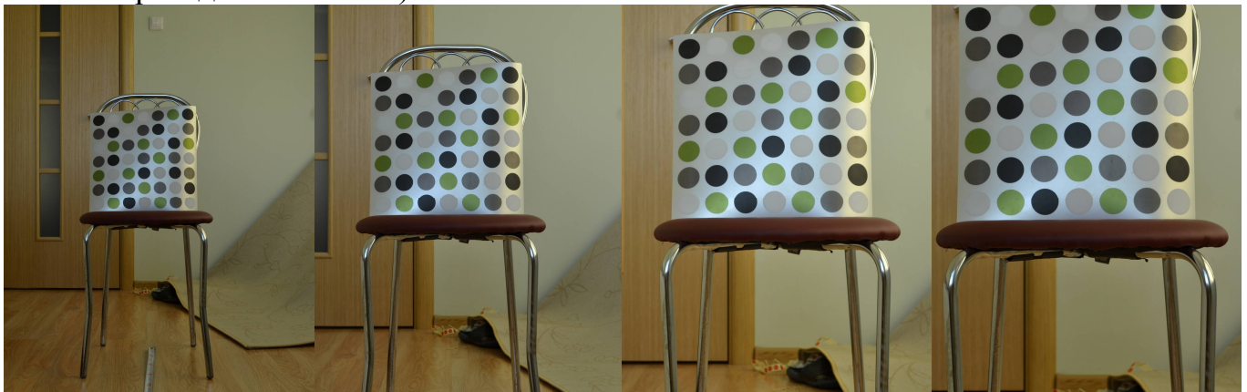
Рис. 4. Изображения, полученные с помощью фотокамеры, при различных фокусных расстояниях: а) 24 мм, б) 35 мм, в) 45 мм, г) 55 мм.
